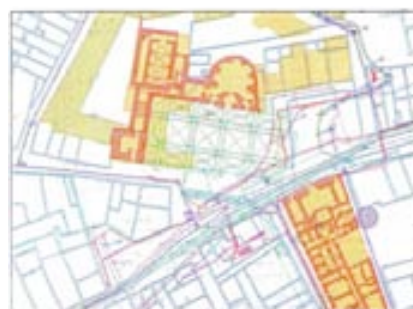
Encombrement du sous-sol par différents réseaux et vestiges d'une ancienne église
